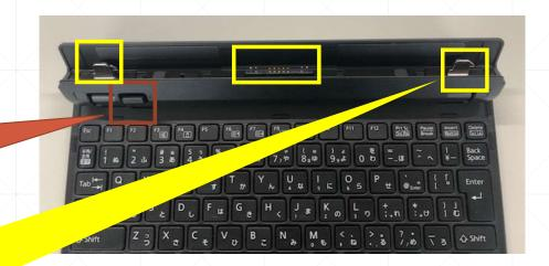
取り付け時は強引には取り付けない! (故障の原因) 枠部分の金具が変形して取付できないようになります
