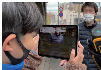
ハザードマップの想定浸水深の水面を目の前の風景に重ねて表示
