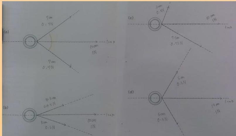
導入で導き出した「2人の持ち上げる角度が変わると、持ち上げるのに必要な2人の力も変わる」という仮説のもと実験を実施
